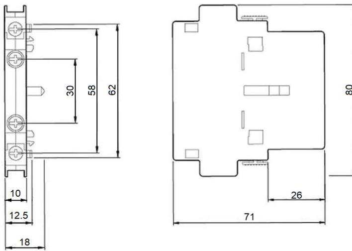
Рисунок 2. Габаритные размеры боковых блок-контактов 3RH1921-EA
